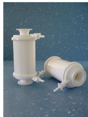
La capsula filtrante QUALIKAP QKP-N presentano caratteristiche ideali per essere utilizzate come filtro finale sterilizzante di piccoli batch nel settore farmaceutico. QUALIKAP QKP-N incorpora la membrana Nylon 6,6 caratterizzata da una porosità controllata che assicura alta efficienza nella ritenzione batterica. Applicazioni tipiche sono le filtrazioni di soluzioni alcooliche, acqua ultrapura, vaccini, soluzioni fisiologiche, liquidi oftalmici etc.
